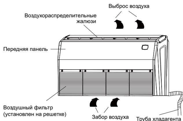
Примечание: внешний вид различных моделей напольно-потолочных блоков одинаковый.
