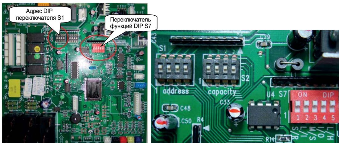
Главная плата управления, переключатель функций DIP - 5 тумблеров.
